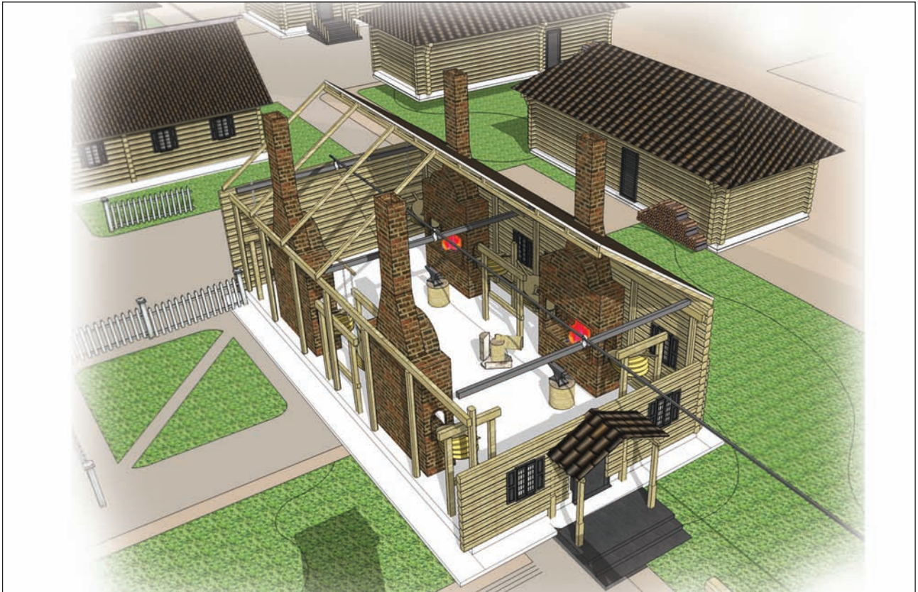
■ Интерпретация кузницы по книге Бакланова «Техника металлургического производства на Урале в XVIII веке»
